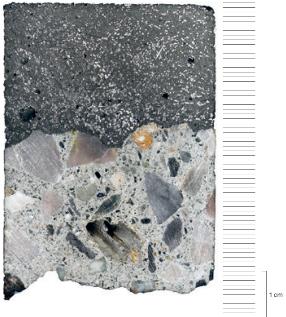
Abb. 1 Auflichtbild einer Kontaktzone zwischen Beton und UHFB. Deutlich sichtbar der Unterschied der Baustoffe (Grösstkorn, Faserbewehrung, Dichtheit)
