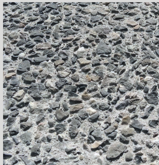
Beispiel einer Waschbetonoberfläche, GK 0-8 mm
