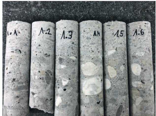
Bohrkerne Ø 50mm des 1. Probeinbaus
